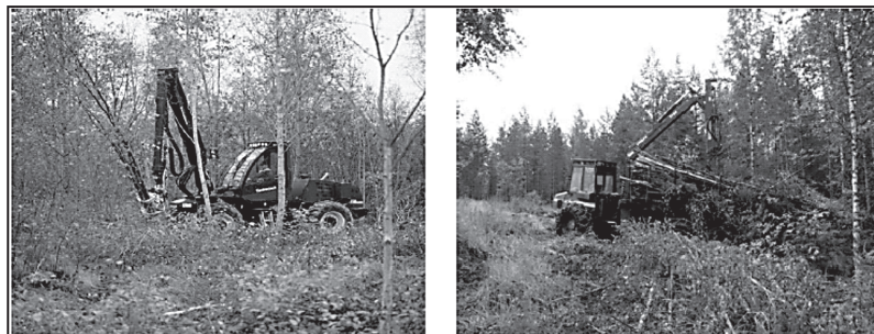
Рис. 3.2. Валка и трелевка тонкомерных деревьев на лесосеке.
