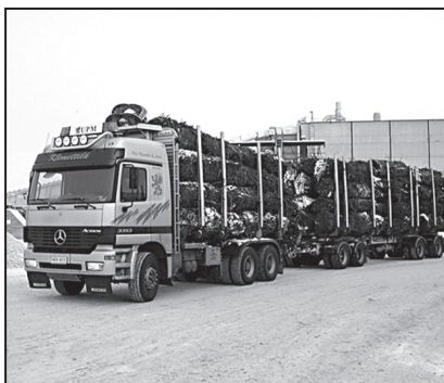
Рис. 4.13. Транспортировка пакетированных БЛС на лесовозе.
