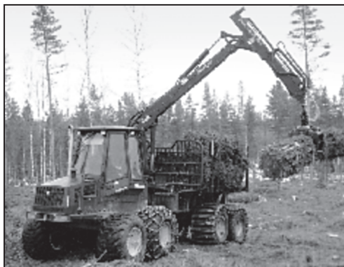
Рис. 4.11. Погрузка пакетированных БЛС на форвардер.
