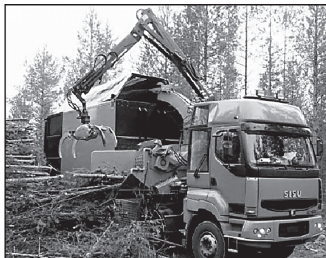
Рис. 4.6. Щеповоз с рубительной машиной.
