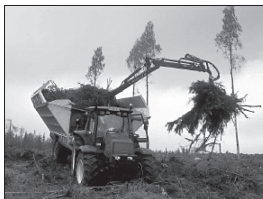
Рис. 4.17. Форвардер-грузоуплотнитель «ХавуХукка» (Harvuhukka), предназначенный для транспортировки лесосечных отходов.
