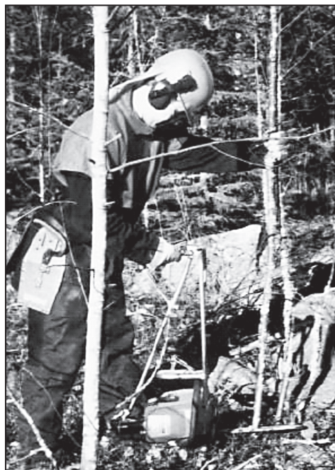
Рис. 5.3. Бензопила, оборудованная валочной рамой с ручками, повышает уровень эргономики и улучшает условия труда при валке и пакетировании тонкомерных деревьев.
