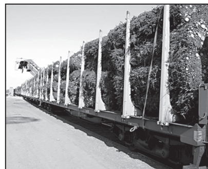
Рис. 4.14. Транспортировка пакетированных БЛС на железнодорожном транспорте.
