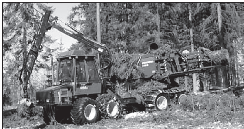
Рис. 4.10. Машина для пакетирования лесосечных отходов «Тимберджэк 1490D».
