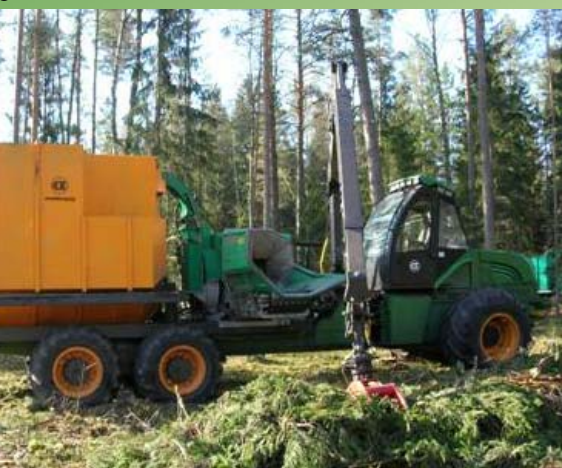
Рис. Рубительная машина МР-40 с приводом от автономного двигателя РУП МТЗ
