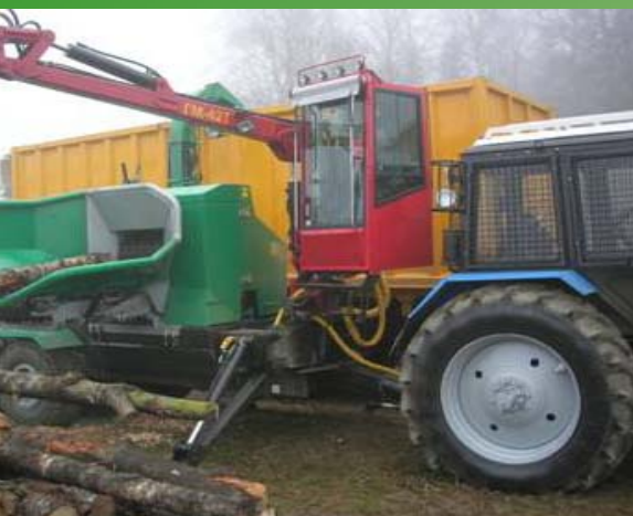
Рис. Рубительная машина МР-40 с приводом от автономного двигателя РУП МТЗ
