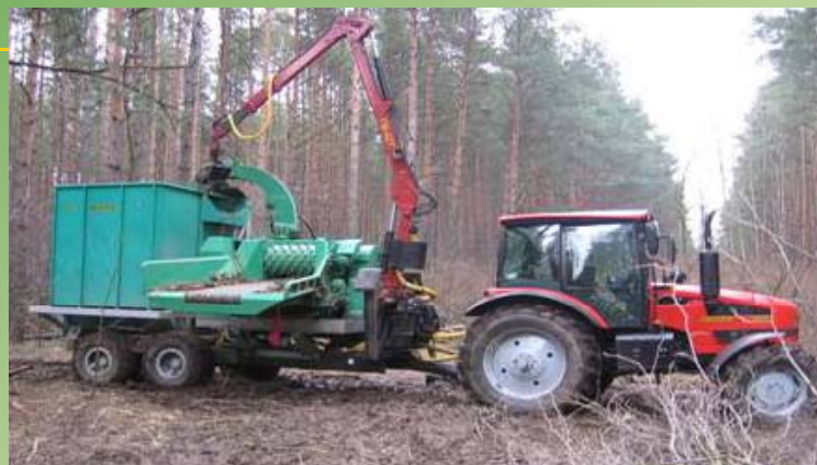
Рис. Руб. машина МР-25 с приводом от ВОМ трак-ра и бункером для щепы РУП МТЗ
