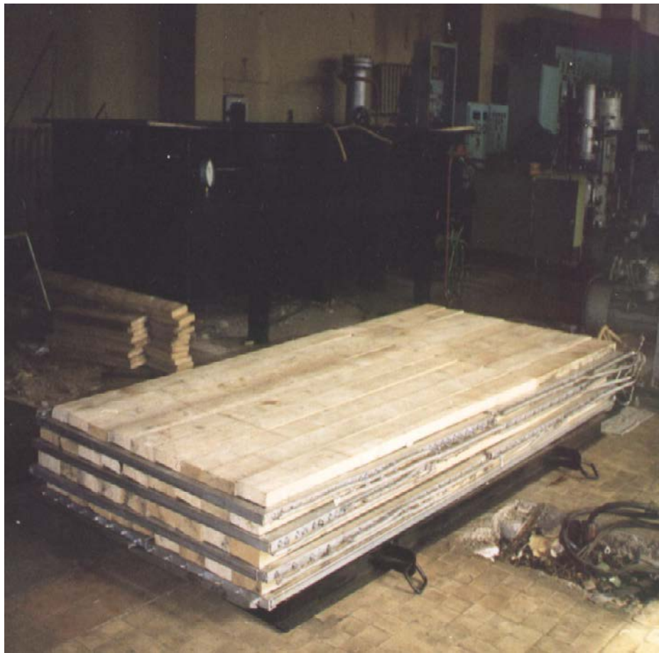
Доски расположены на алюминиевых панелях
