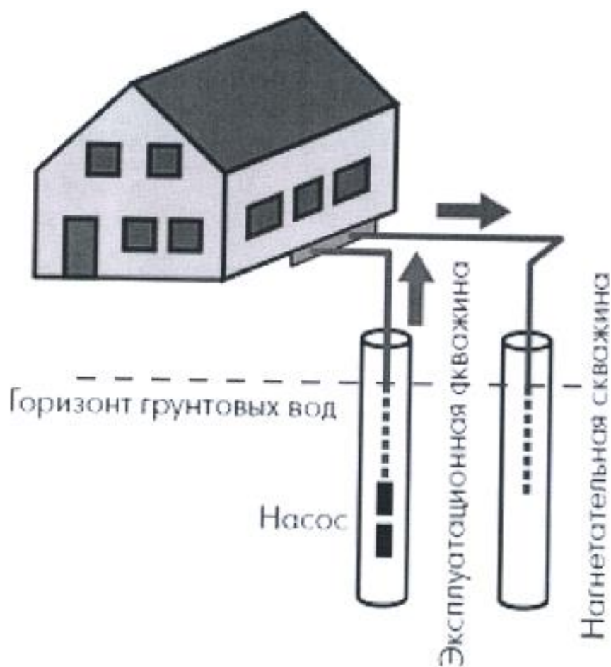
Рисунок 1.9 – Использование вертикальных грунтовых теплообменников в тепловых насосах
