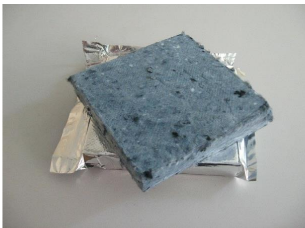
Рисунок 14 – Лабораторный образец брикета наполнителя и вакуумной теплоизоляционной панели
