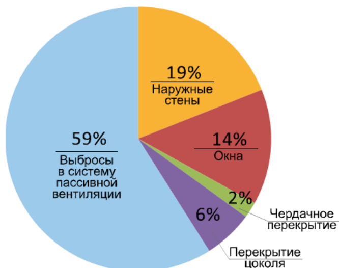
Рисунок 1.5 Распределение потерь теплоты в стандартных жилых домах, построенных по существующим нормативам.
