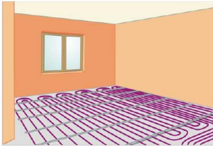
Рисунок 5 - Фрагмент меандрового контура трубопровода напольной системы отопления
