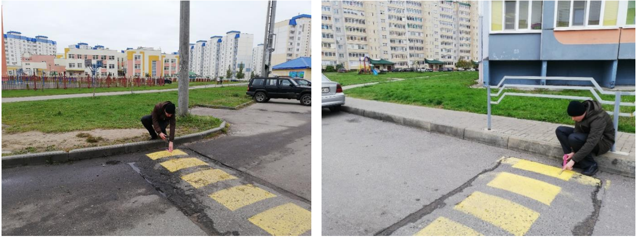
Рисунок 9 – Определение высоты искусственной неровности у ГУО «Средняя школа №45 г. Могилева»
