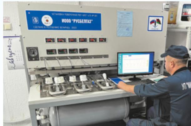
Высокая производительность является выгодным отличием данной установки от других аналогов, применяемых для поверки счётчиков газа струйного типа, на которых время поверки такого же количества счётчиков может достигать 6–8 часов.
