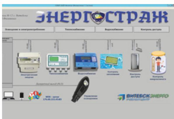
Средство диспетчеризации для визуализации процессов управления и контроля выполнено на базе современной SCADA-системы «Simp Light».
