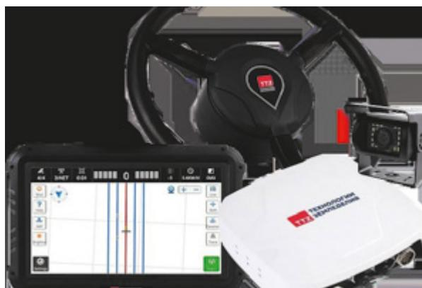
За счет перестановочного комплекта систему автоматического вождения возможно использовать на нескольких единицах техники, поочередно и поэтапно переходя с энергонасыщенных тракторов при почвоподготовке и севе на менее мощные трактора при внесении жидких минеральных удобрений, а также внесении средств защиты растений.
